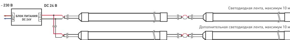
Рисунок 2. Схема подключения лент к источнику питания при температуре окружающей среды менее  $+40^{\circ}\text{C}$ .
